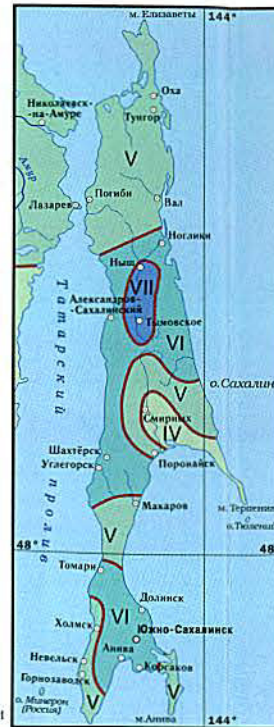
КАРТА 1а. РАЙОНИРОВАНИЕ ТЕРРИТОРИИ ОСТРОВА САХАЛИН ПО РАСЧЕТНОМУ ЗНАЧЕНИЮ ВЕСА СНЕГОВОГО ПОКРОВА
